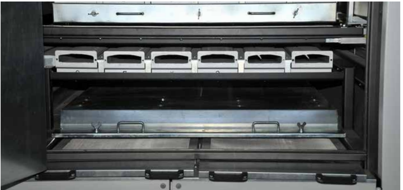
Uçları açılabilen hava kanalları ile kolay ve hızlı düze temizliği / Easy and quick self cleaning nozzle system
