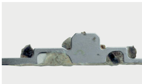
Agulha de perfil baixo de forma meândrica
