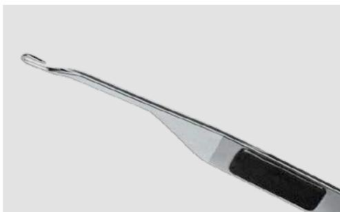
Para as espessuras a partir de E 40, a Groz-Beckert desenvolveu e patenteou uma agulha composta especial com espessamento em plástico. A particularidade da agulha Spec. 51/ 43.36 G 101? Seu espessamento lateral em plástico dá às agulhas finas estabilidade suficiente durante a formação da laçada.
