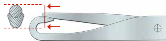
Agulha com gancho côncavo: lingueta palito
